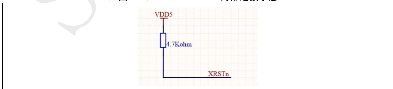
图 2-1: SPD1148 XRSTn 内部连接示意
